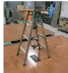
転倒衝突時のかたさ試験
