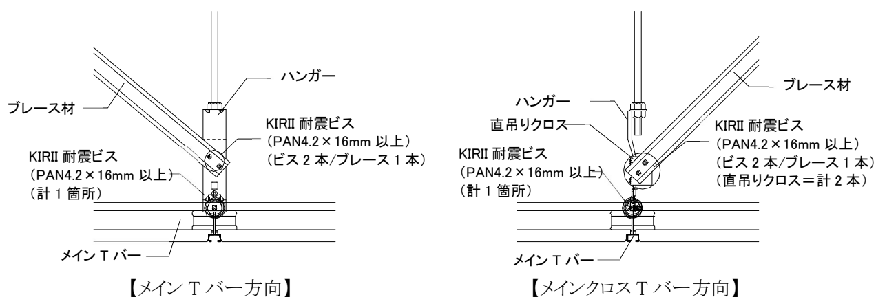
図 1-2-2 ブレース設置部の名称
