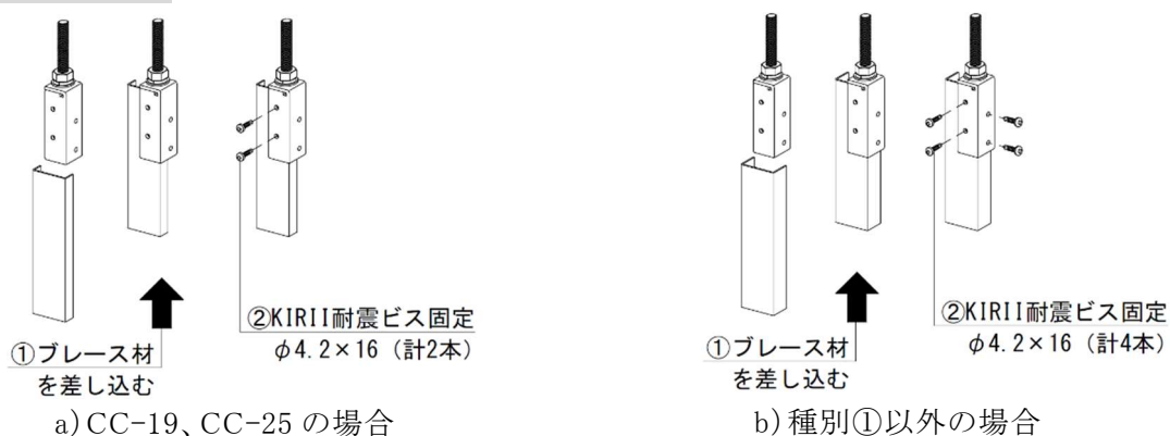
図 2-5-3 ブレースエッジボルトの施工方法
