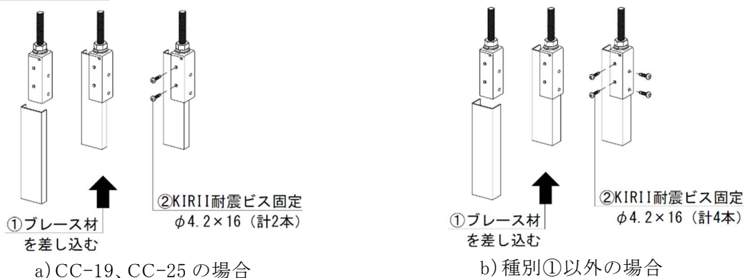
図 2-5-3 ブレースエッジボルトの施工方法
