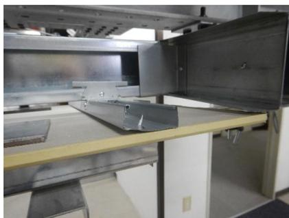
終局状況：野縁の倒れによりボードビスが引き抜かれ荷重が低下したため試験終了とした。
