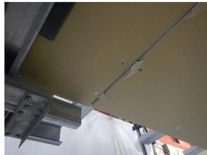
終局状況：仕上げ材の目地部の損傷により試験終了とした。
