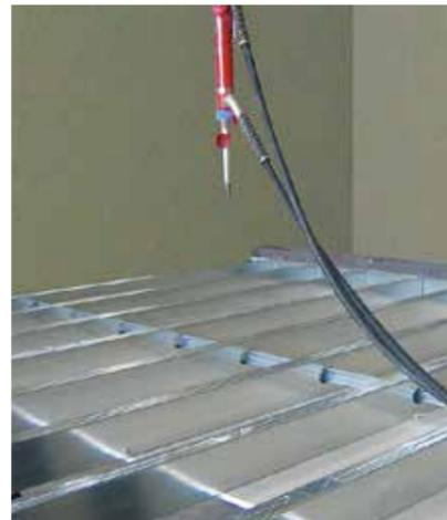
寝かせた状態の壁に重力(1G)をかけることにより、実際の立っている状態の壁に地震時の水平加速度(1G)がかかった場合を想定した試験です。
