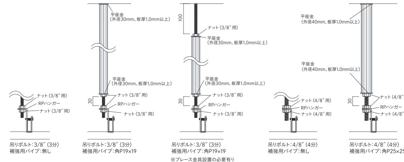
※緩み止め対策を施す場合、ばね座金やナットゆるみ止め・脱落防止金具(インスタントロック:3分ボルトのみ)を使用してください。
