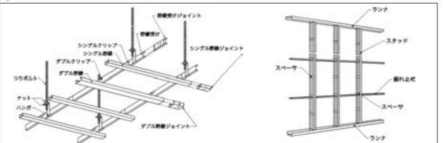
鋼製下地材は、使用用途によって壁下地材と天井下地材とに区分し、壁下地材及び天井下地材の構成部材及び附属金物並びに構成部材の組合せは、次による。
