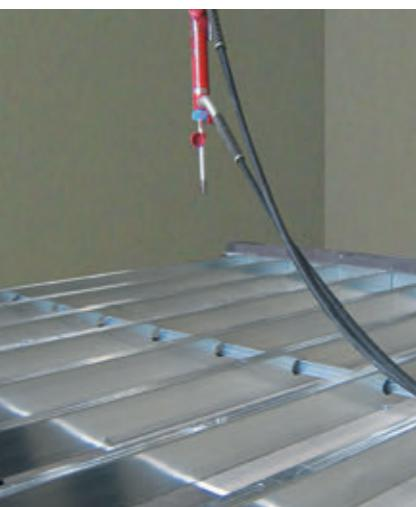
寝かせた状態の壁に重力(1G)をかけることにより、実際の立っている状態の壁に地震時の水平加速度(1G)がかかる場合を想定した試験です。
