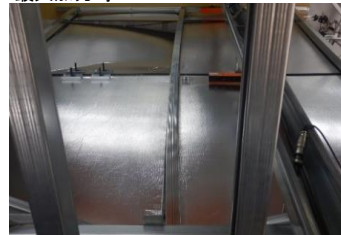
SQ-BARの変形、仕上げ材の損傷
