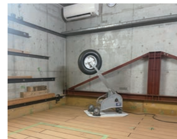
バングマシン：重量床衝撃音を発生
