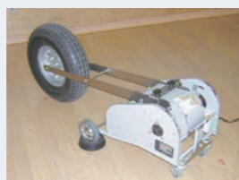
バングマシン： 重量床衝撃音を発生
