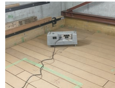
タッピングマシン：軽量床衝撃音を発生
