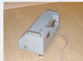
タッピングマシン： 軽量床衝撃音を発生
