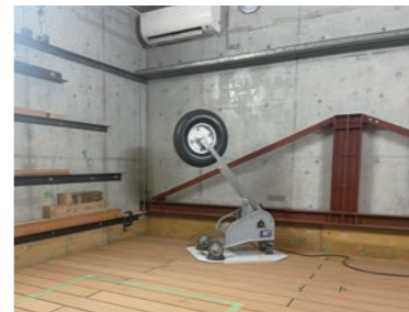
バングマシン：重量床衝撃音を発生
