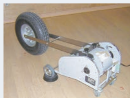
バングマシン： 重量床衝撃音を発生
