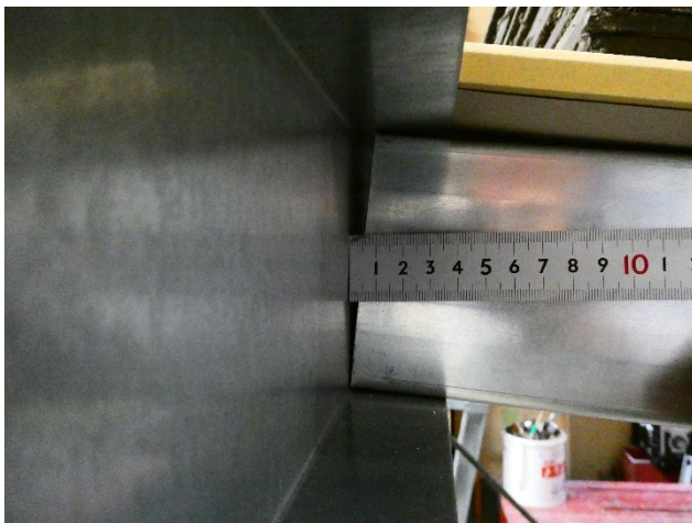
写真 9 最大荷重時 下部ランナー
