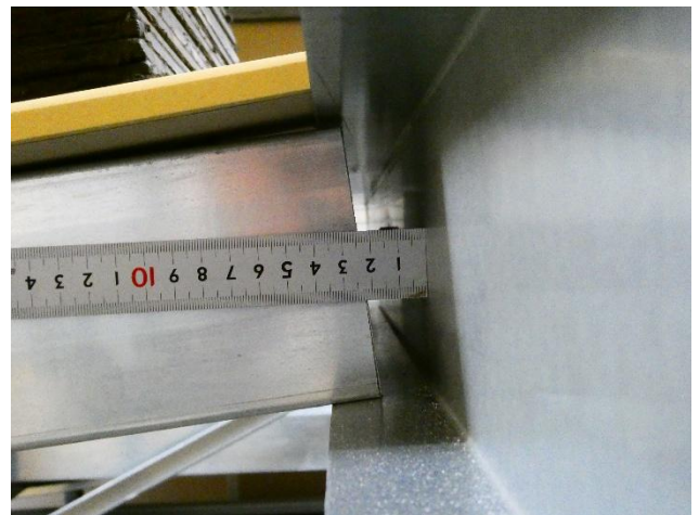
写真 10 最大荷重時 上部ランナー
