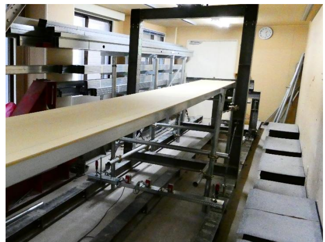
写真 6 試験実施状況 変位計設置
