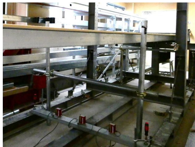
写真 6 試験実施状況 変位計設置
