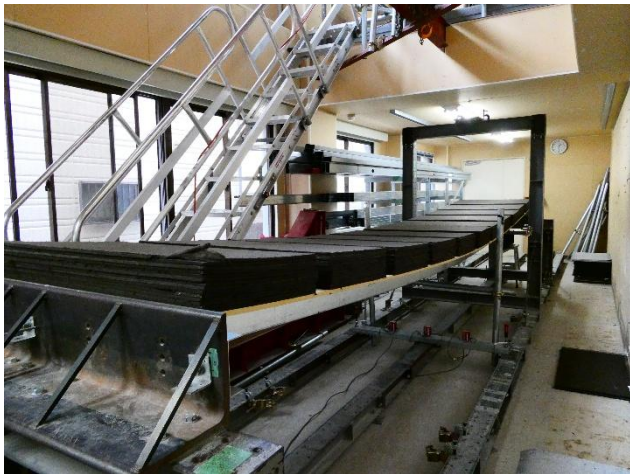
写真 7 最大荷重時 高比重アスファルト系面材設置
