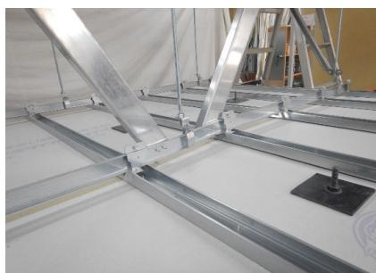
終局状況：野縁受けの変形、野縁の倒れにより損傷が明らかとなため終局とした。
