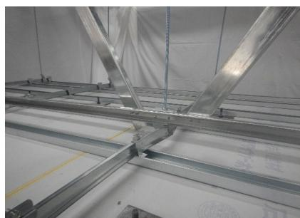
終局状況：圧縮側のプレースと野縁受け繋ぎ材を繋ぐビスの破断により終局とした。
