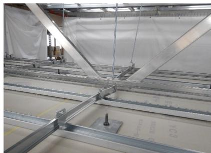
終局状況：野縁受けの座屈、野縁のたおれにより損傷が明らかなため終局とした。
