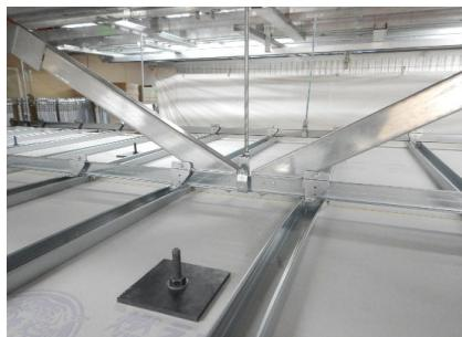
終局状況：野縁の倒れにより損傷が明らかなため終局とした。
