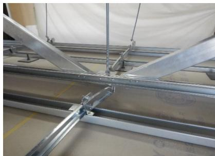
終局状況：ブレース下部付近のボードビスが抜けて加力低下したため終局とした。
