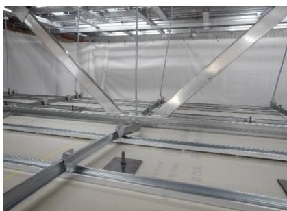
終局状況：フレース近傍部にてボードからビスが引き抜け荷重が低下したため終局とした。
