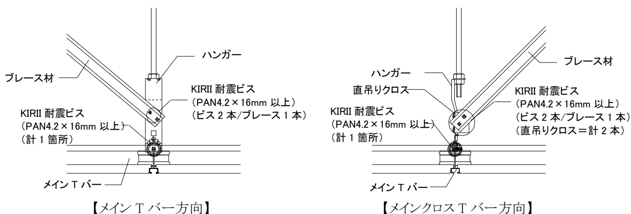
図 1-2-2 ブレース設置部の名称
