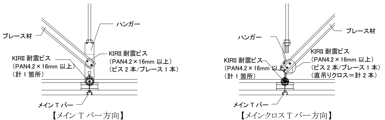
図2-7-7 ブレース下部取付詳細
