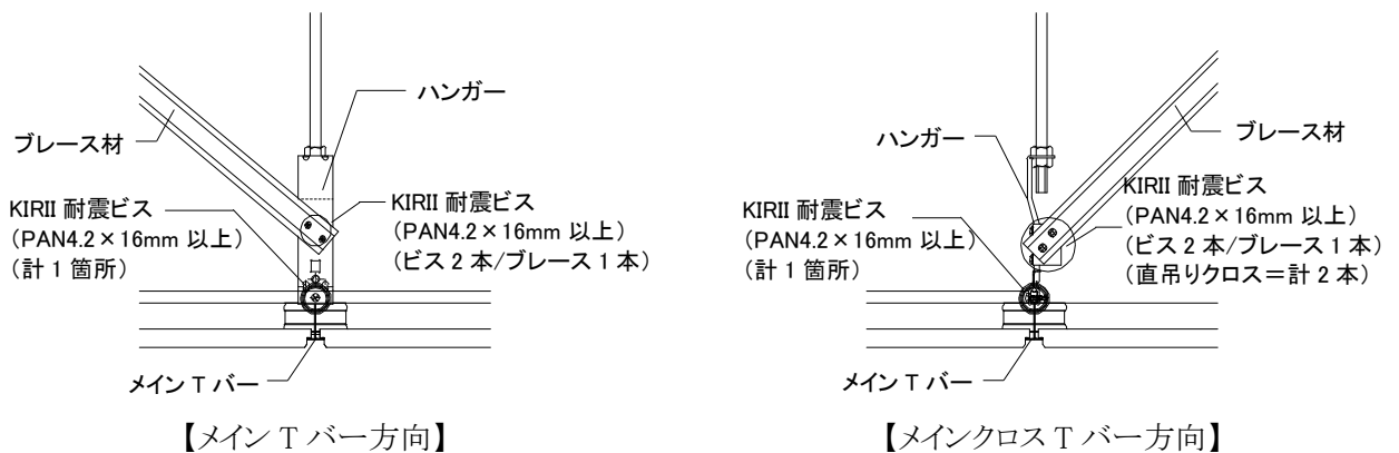
図2-7-7 ブレース下部取付詳細
