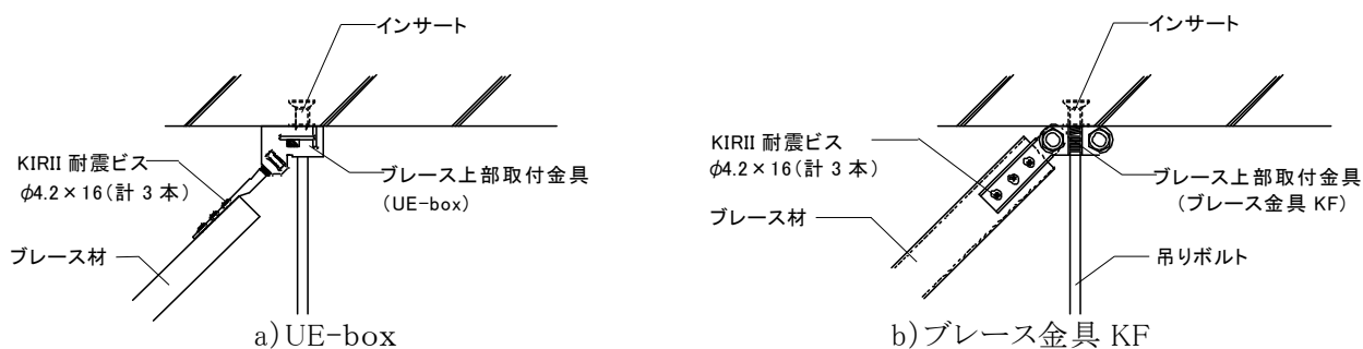
図 2-6-5 ブレース上部取付け詳細③
