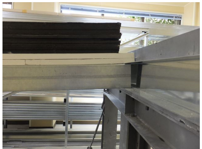
写真10 試験実施状況 上部ランナー側面（最大加力時）
