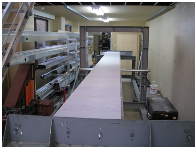
写真4 試験体施工状況 全景 (上面：タイガーボードタイプ Z 21mm)
