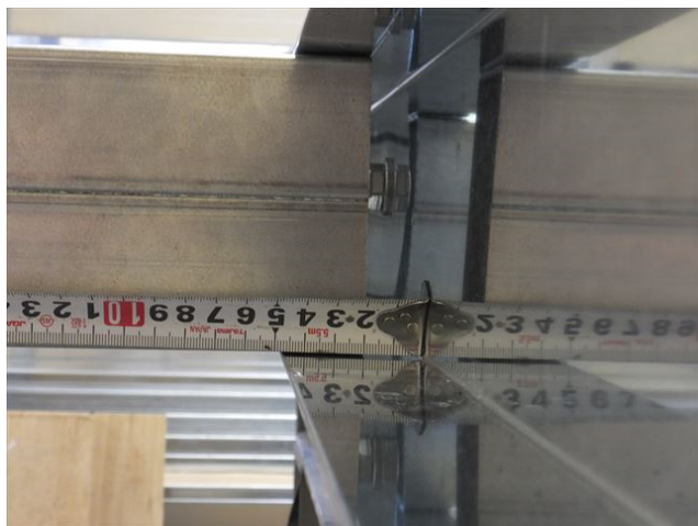
写真3 試験体施工状況 上部ランナーあき寸法 20mm
