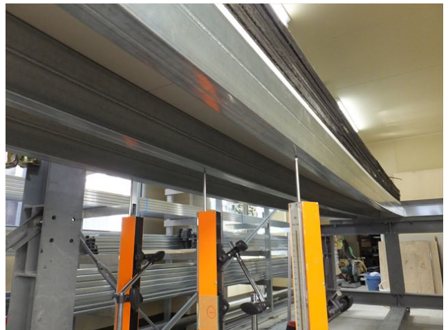
写真8 試験実施状況 変位計測（最大加力時）
