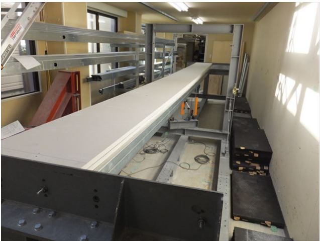
写真 11 試験終了後状況 全景 重大な損傷、外れなし
