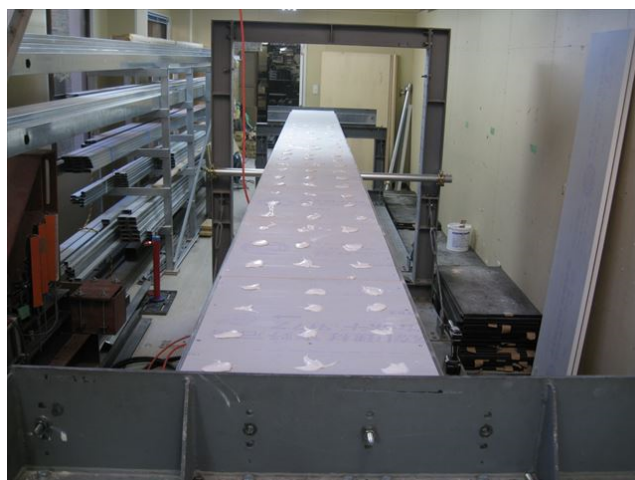
写真6 試験体施工状況 タイガートラボンド貼り付け
