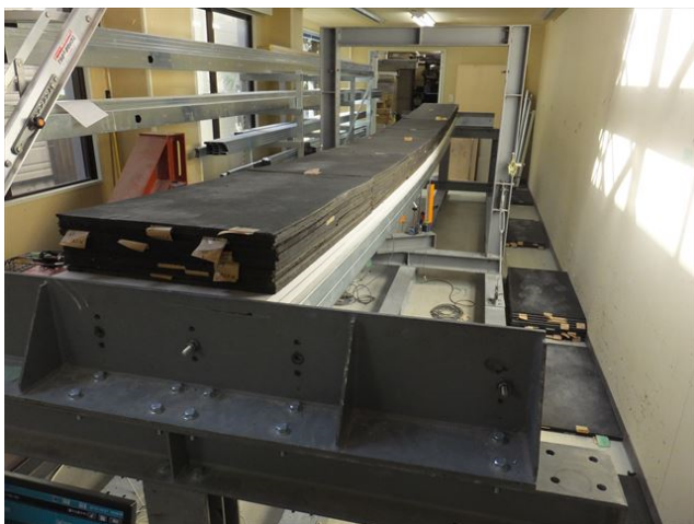
写真9 試験実施状況 高比重アスファルト系面材設置（最大加力時）
