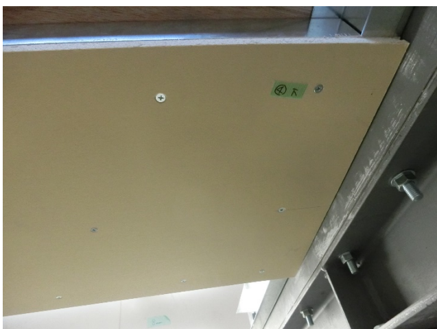
写真5 試験体施工状況 下面：せっこうボード 12.5mm
