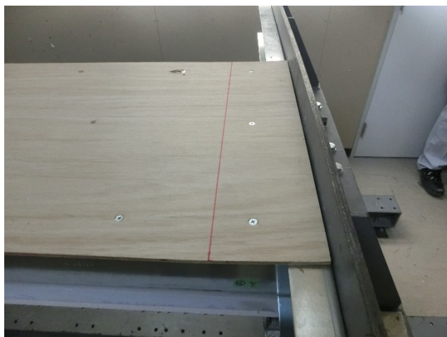
写真4 試験体施工状況 上面：合板 5.5mm
