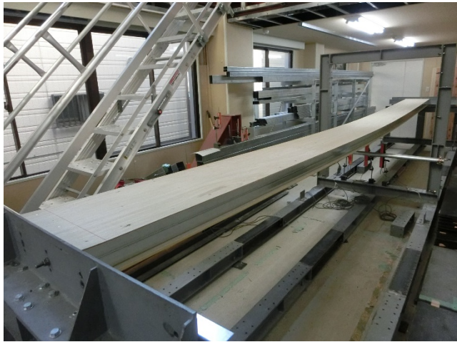
写真 11 試験終了後状況 全景 重大な損傷、変形、外れなし
