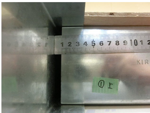
写真6 試験体施工状況 上部クリアランス 10mm
