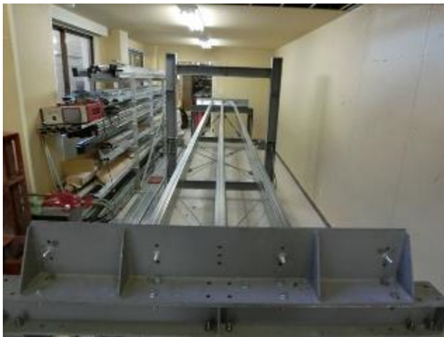
写真 1 試験体施工状況 鋼製下地材正面全景
