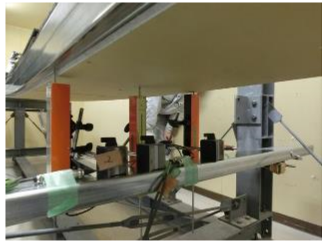
写真 8 試験実施状況 変位計測
