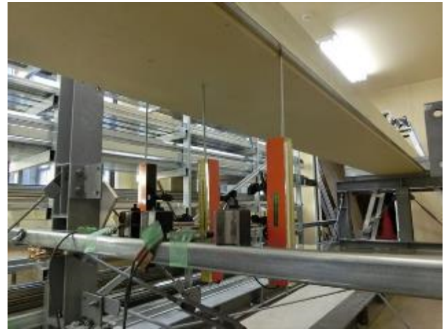
写真 6 試験実施状況 変位計設置
