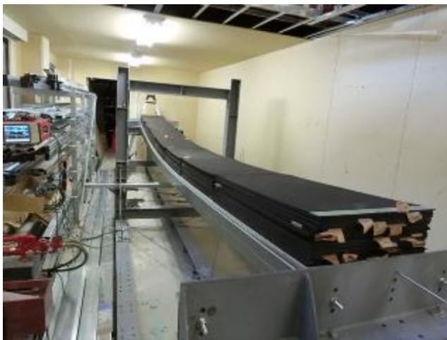
写真 7 試験実施状況 高比重アスファルト系面材設置
