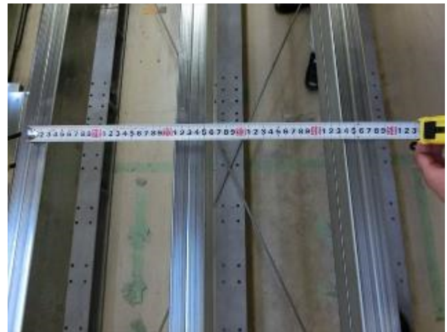
写真 2 試験体施工状況 スタッド間隔 227.5mm
