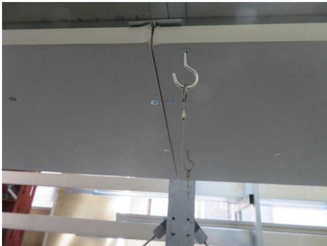
写真 14 試験終了後状況 中央部目地 重大な損傷、変形、外れなし
