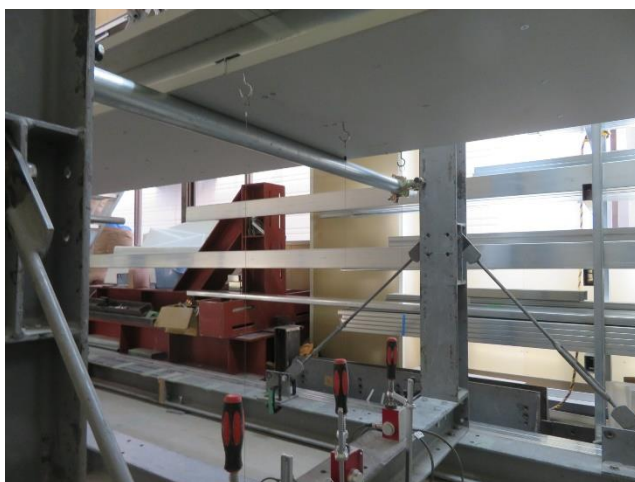
写真 6 試験体施工状況 変位計設置
