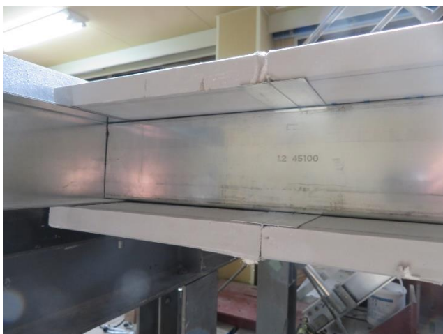
写真 4 試験体施工状況 上面・下面：強化せっこうボード タイプ V25mm
