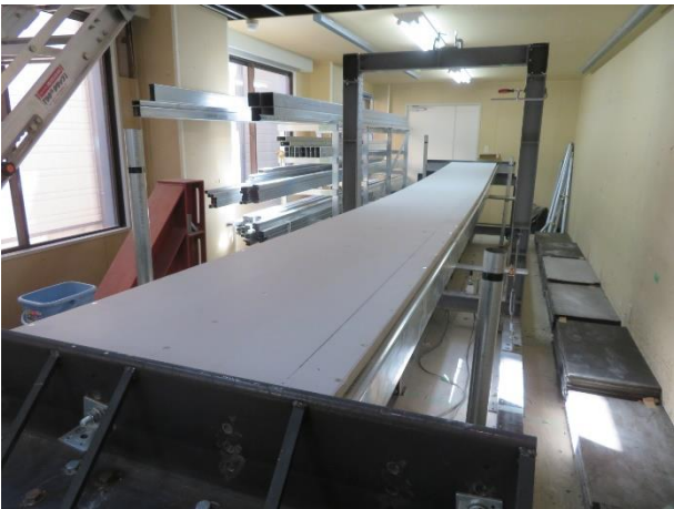
写真 13 試験終了後状況 全景 重大な損傷、変形、外れなし
