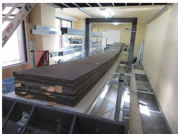
写真9 試験実施状況 高比重アスファルト系面材設置
