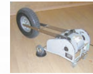
重量床衝撃音発生器 (バングマシン)
