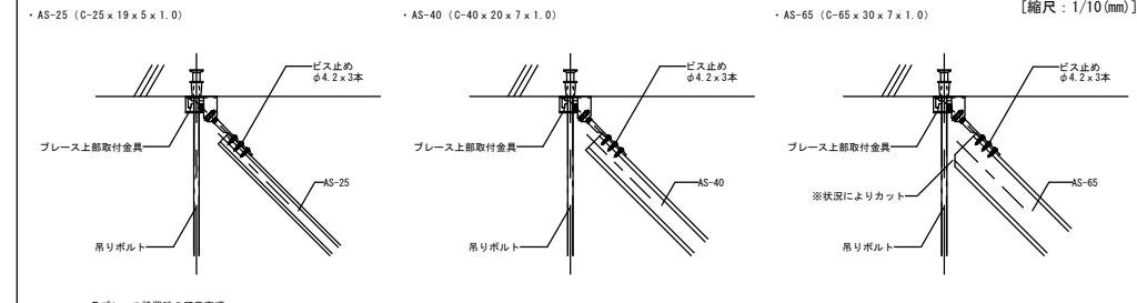
□開口補強詳細図 (伏図)
