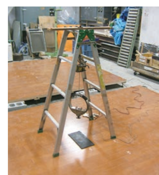
転倒衝突時の硬さ試験により、安全性を確認しています。
