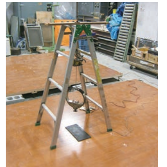
転倒衝突時の硬さ試験により、安全性を確認しています。
