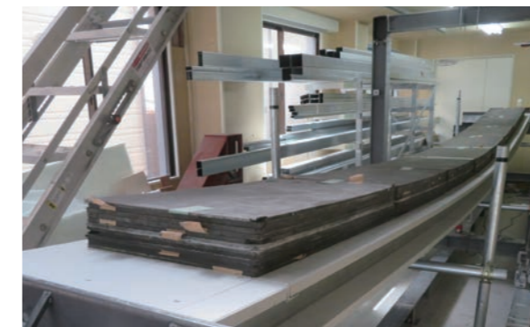
壁を水平な状態に設置し、壁面上部に2500N/m 2 以上の重りを載せ、重力により下方向に加力しました。
