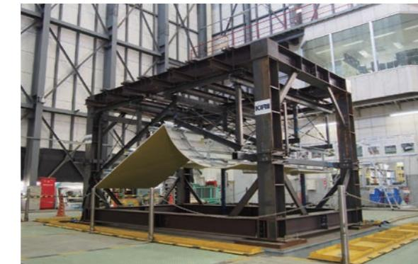
「吊らない」ことで複雑な形状の天井にも対応、振動台実験にて安全性を確認済み
