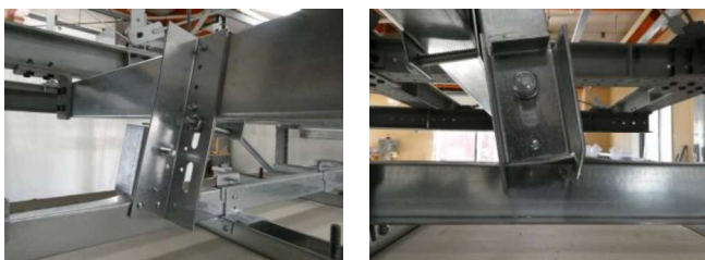
写真 4 最大荷重時状況（1 構面部分モデル試験）
